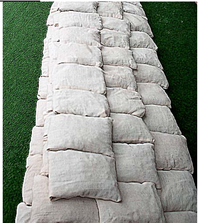
Foto 7: Aufkaden am Model, Verlegeart 1
